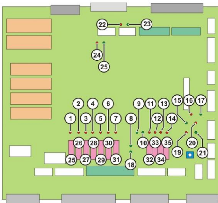
11-4: CI3 工艺板保险装置及各 LED 指示灯
